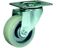
M859 - Pag.97 Núcleo Aluminio Inyectado a bolas Banda Silicona anticalorica 250° Alta Temperatura.
